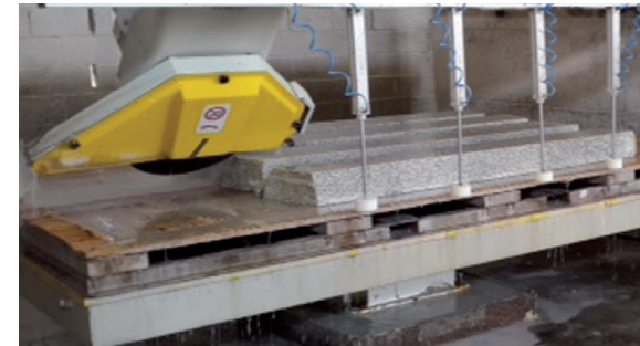
Inclined cuts. Tagli inclinati.
