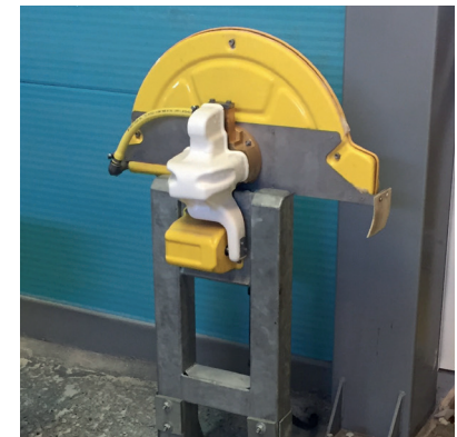
COD. A1731 AUTOMATIC DISC CHANGER CAMBIO AUTOMATICO DISCO
